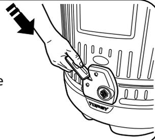
**2** Insérez la clé dans la serrure (ne pas tourner la clé). Ceci libérera automatiquement le mécanisme de verrouillage.
