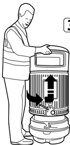
**3** Laissez la clé dans la serrure, faites pivoter le corps de la poubelle dans le sens inverse des aiguilles d'une montre, et soulevez le corps de la poubelle au-dessus de l'insert. (cf. remarque A)
